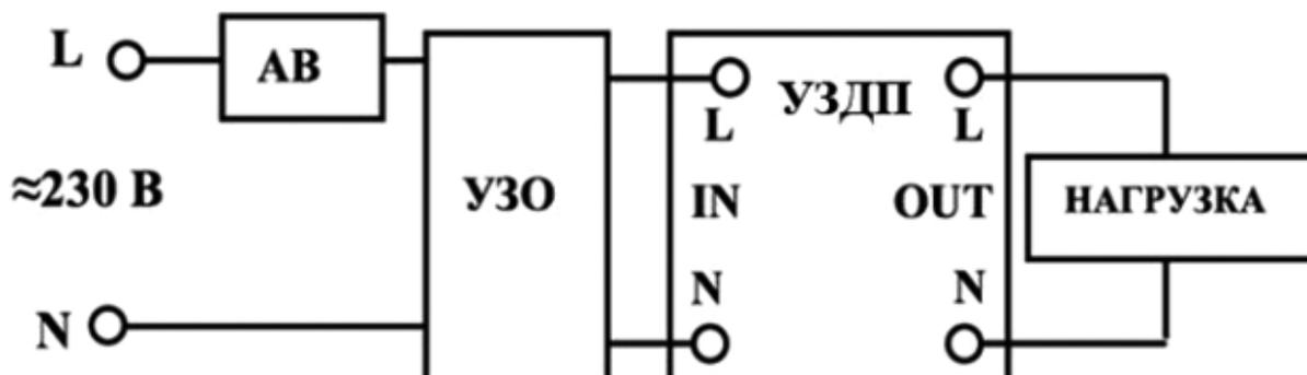
в) Подключение УЗДП с АВ и устройством защитного отключения (УЗО)
