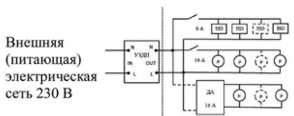
НО - нагрузка осветительная; Р - розетки; ДА - дифавтомат (вариант) в удаленном щитке; номинальный ток УЗДП в примере - 40 А
