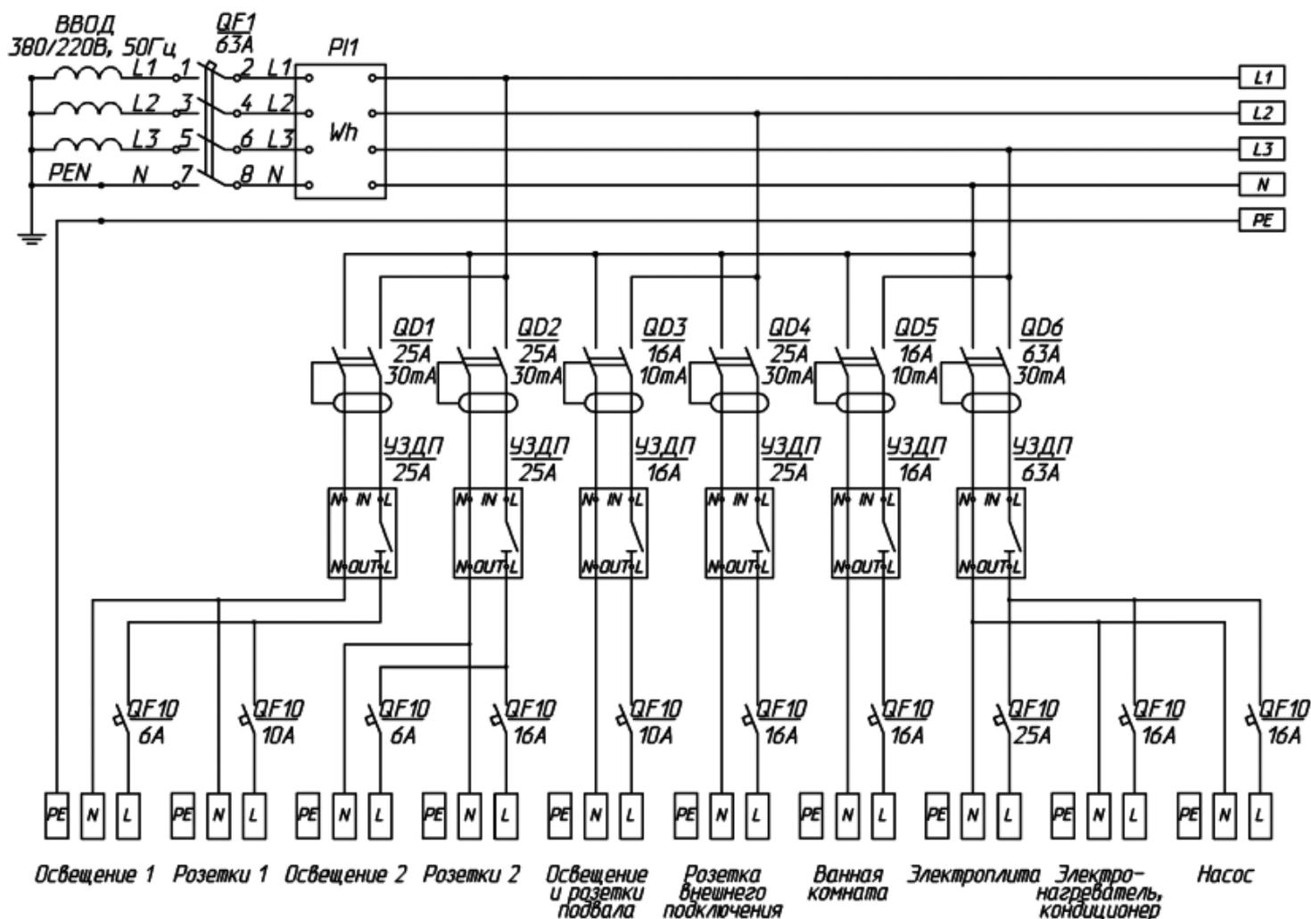
Рисунок В.5 - Электроустановка одноквартирного жилого дома (вариант). Система питания с типом заземления TN-C-S.
