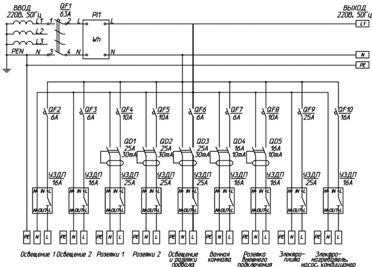
Рисунок В.4 - Электроустановка жилого дома (вариант). Система питания с типом заземления TN-C-S. Схема подключения УЗДП к электрической сети каждого отдельного электроприемника
