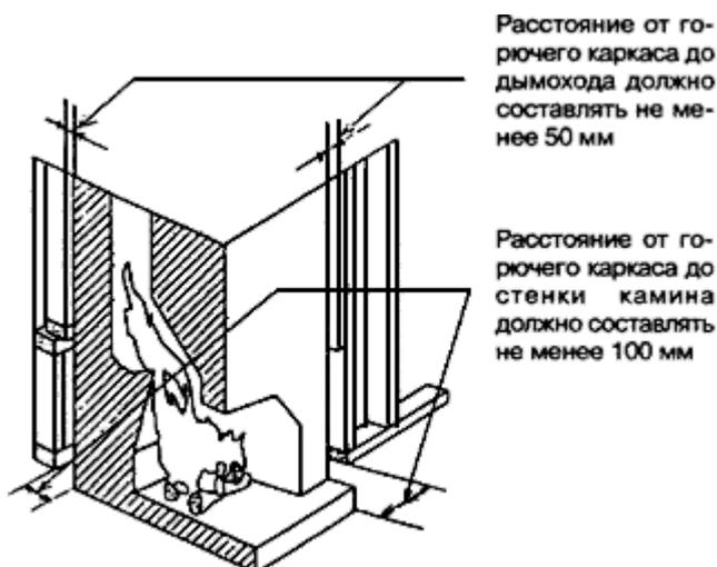
Рисунок 13-2 - Расстояние от стенок камина до каркаса здания
