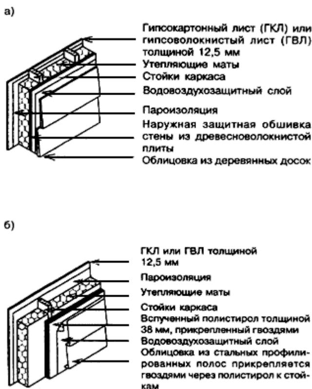
а - утеплитель между стойками каркаса стены; б - утеплитель между стойками каркаса стены с дополнительным слоем жесткого утеплителя снаружи
