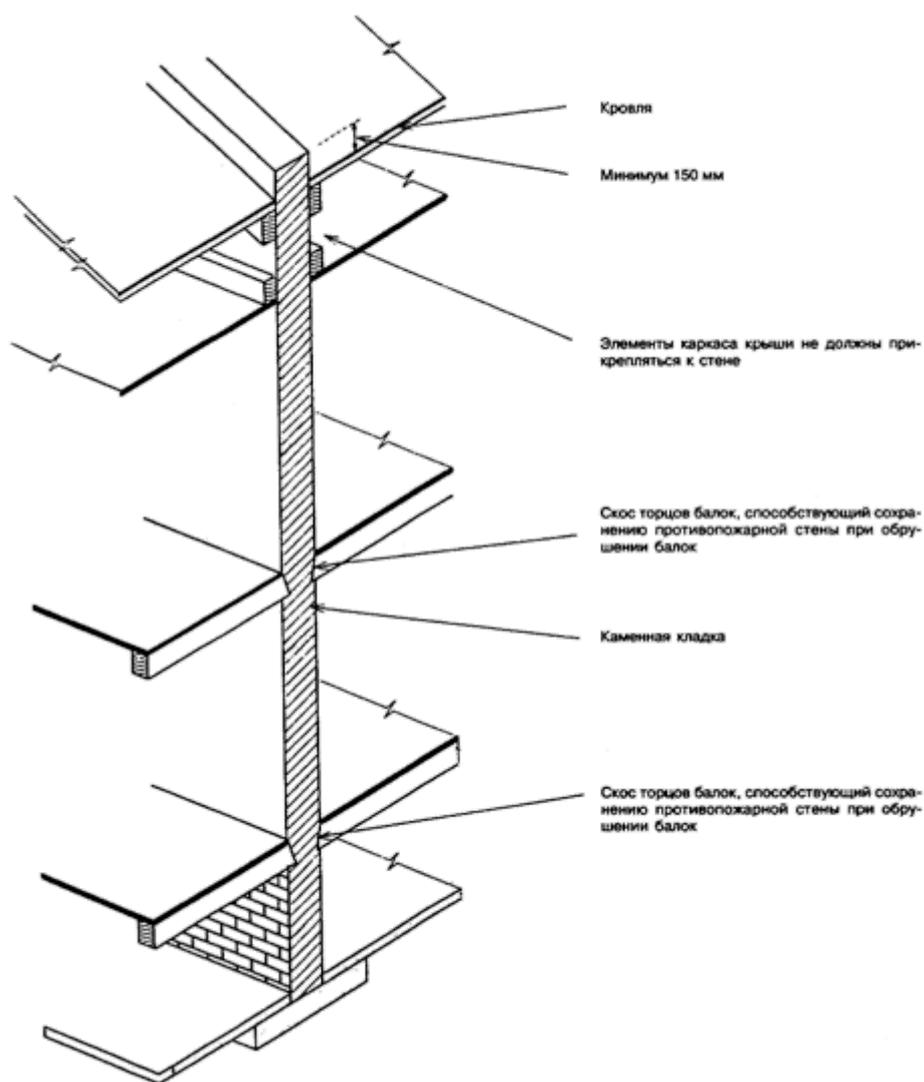
Рисунок 7-5 - Каменная противопожарная стена
