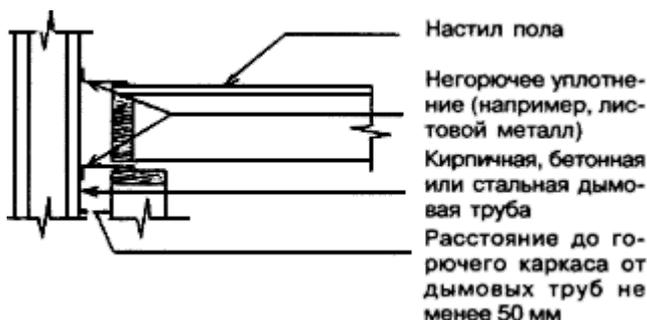
Рисунок 13-3 - Расстояние от дымовой трубы до строительных конструкций
