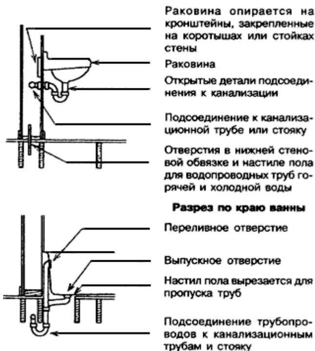
Рисунок 13-6 - Детали установки умывальника и ванны
