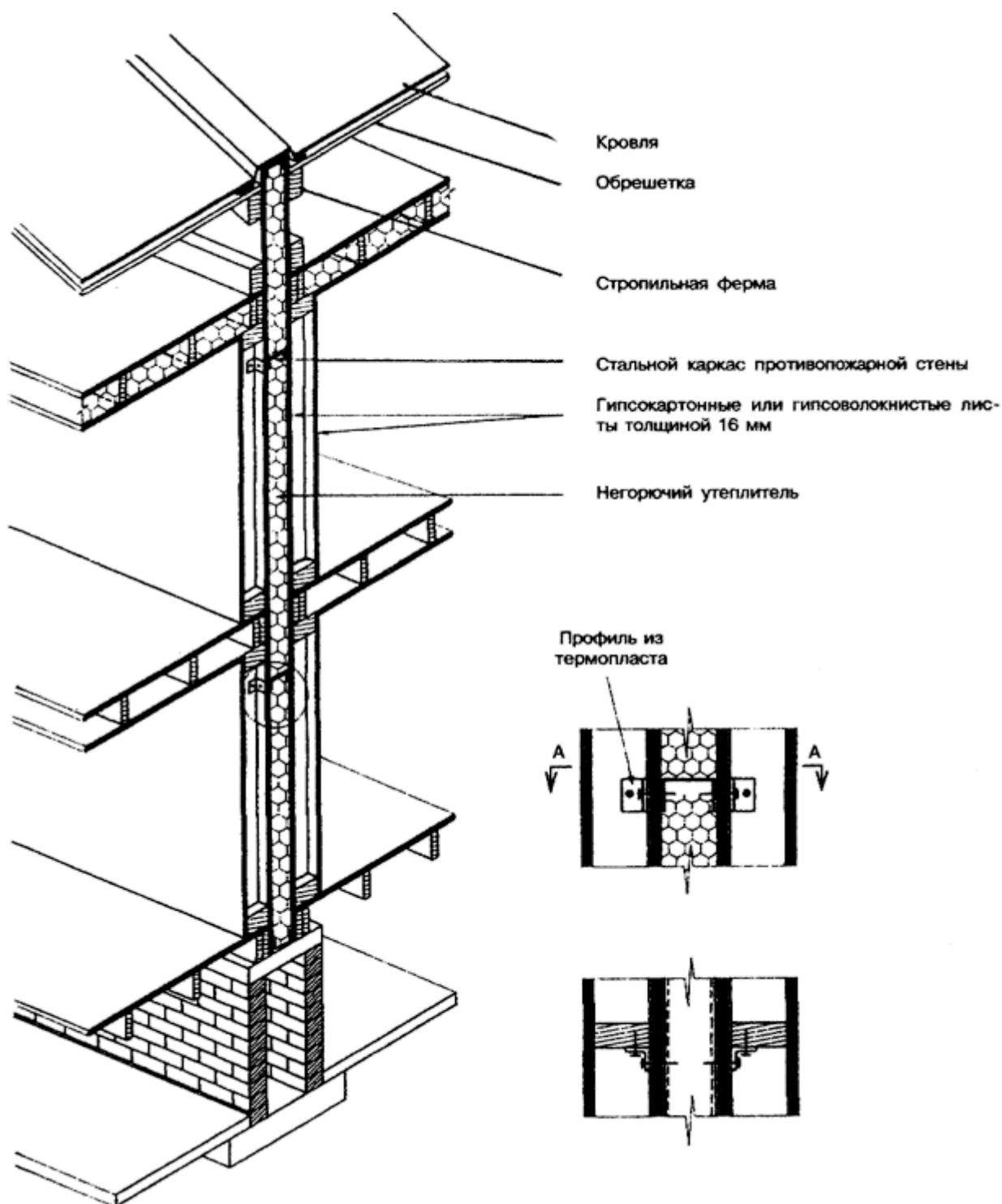
Рисунок 7-6 - Межквартирная противопожарная стена 2-го типа каркасной конструкции
