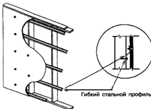
Рисунок 7-8 - Крепление обшивки каркаса для обеспечения звукоизоляции
