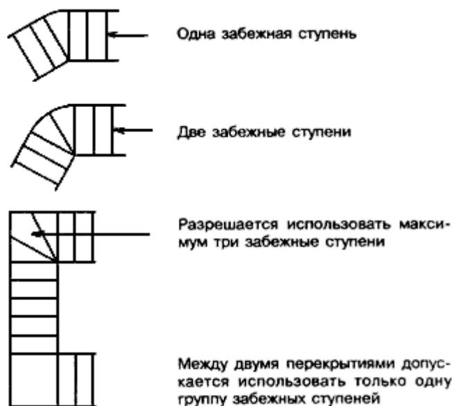
Рисунок 12-1 - Криволинейные лестницы и лестницы с забежными ступенями
