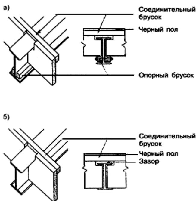
а - балки опираются на деревянные бруски, уложенные на нижние полки прогона; б - балки опираются непосредственно на нижние полки прогона
