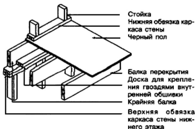
Рисунок 7-4 - Деталь установки доски для крепления внутренней обшивки
