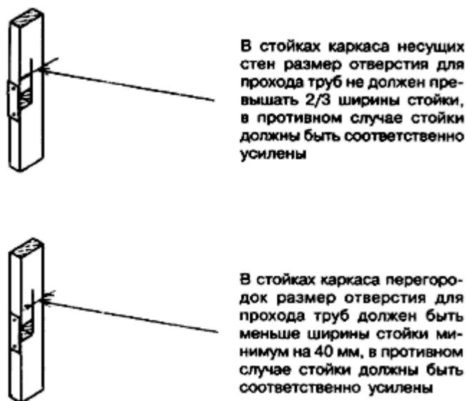
Рисунок 13-7 - Вырезы в стойках каркаса для прохода труб
