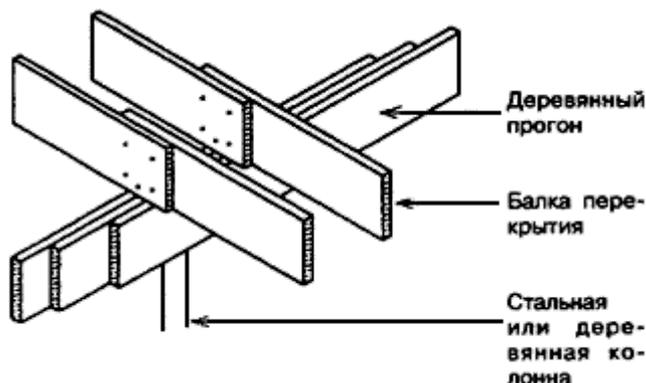
Рисунок 6-7 - Опирание балок перекрытия на деревянный прогон
