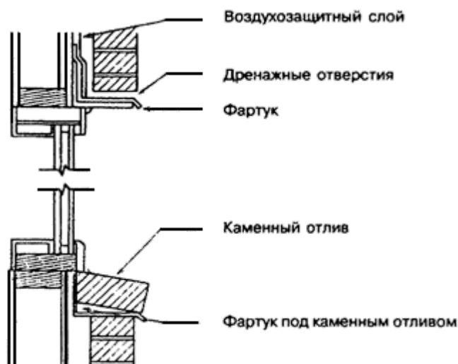
Рисунок 10-2 - Установка фартука под каменным отливом
