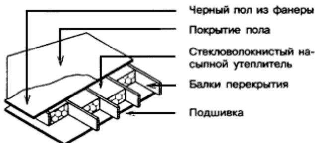
Рисунок 9-3 - Утепление перекрытий над неотапливаемыми помещениями
