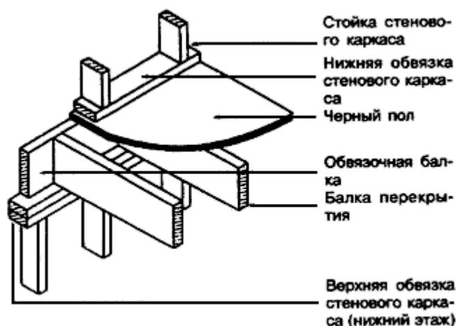
Рисунок 6-6 - Опирание балок перекрытия на каркас наружной стены
