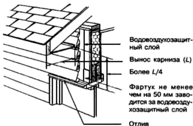
Рисунок 10-4 - Фартук над оконным (дверным) проемом
