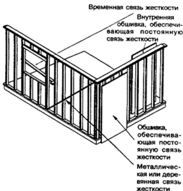
Рисунок 7-1 - Каркас стены
