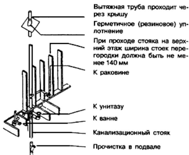
Рисунок 13-8 - Прокладка канализационных труб в каркасе дома
