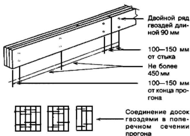
Рисунок 6-1 - Деревянные прогоны составного сечения
