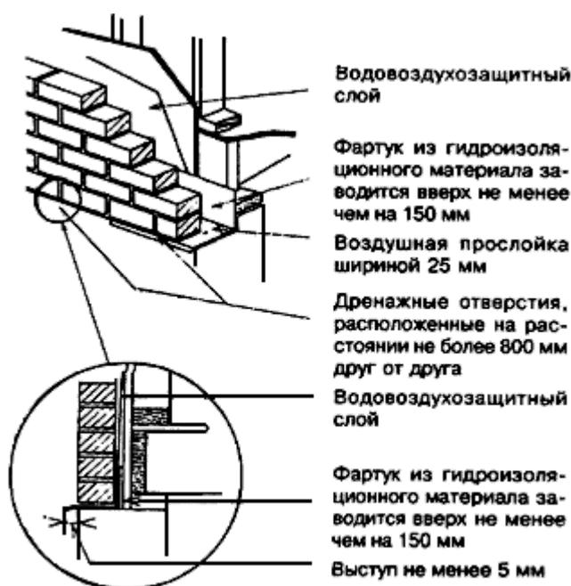
Рисунок 10-3 - Фартук под дренажными отверстиями каменной облицовки
