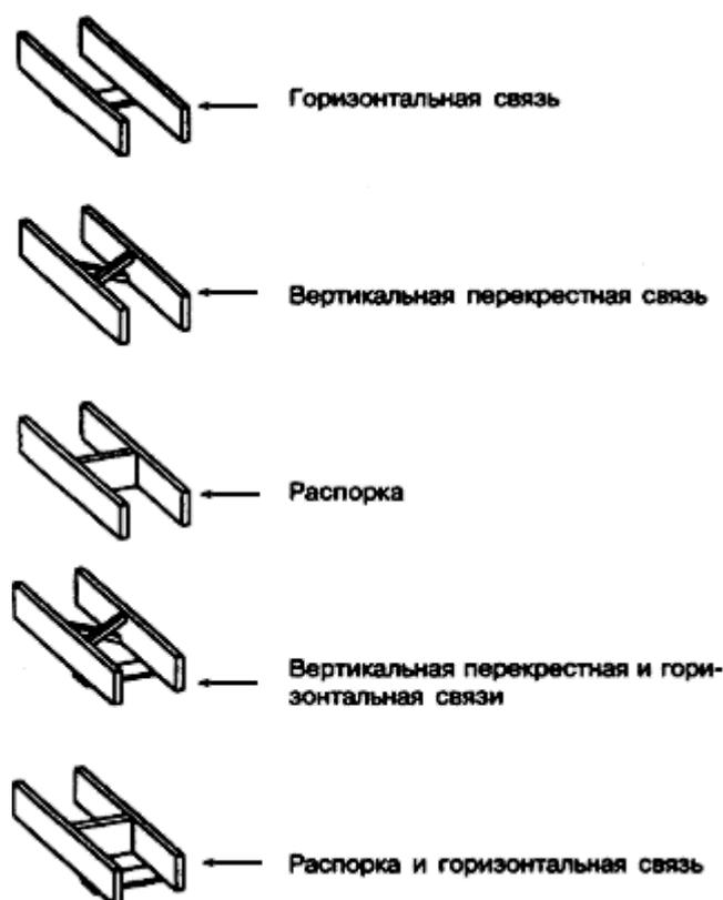
Рисунок 6-10 - Способы раскрепления балок
