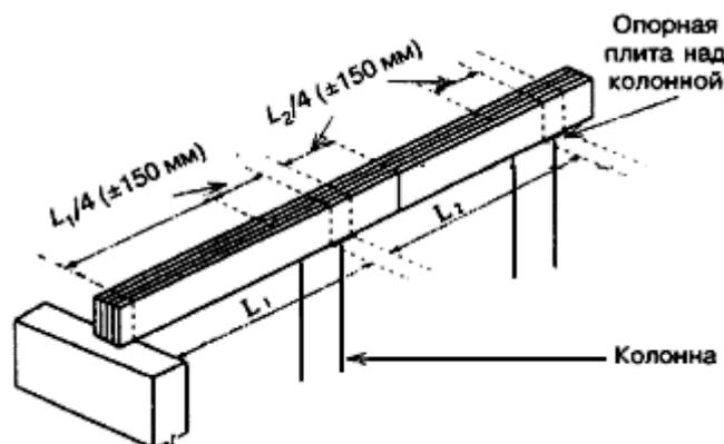
Рисунок 6-2 - Стыки досок в неразрезных прогонах составного сечения
