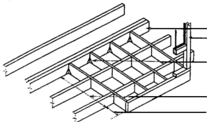
Сдвоенная балка перекрытия
