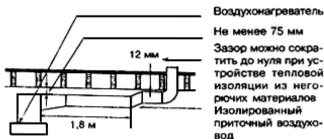
Рисунок 13-1 - Воздуховоды воздушного отопления
