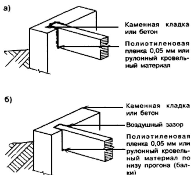
а - низ прогона (балки) расположен над уровнем грунта; б - низ прогона (балки) на уровне грунта или ниже
