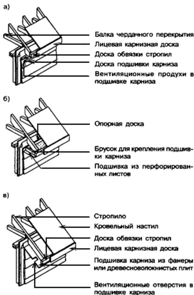
а - вынос карниза не более 300 мм; б - вынос карниза более 300 мм, подшивка карниза горизонтальная; в - вынос карниза более 300 мм, подшивка карниза наклонная
