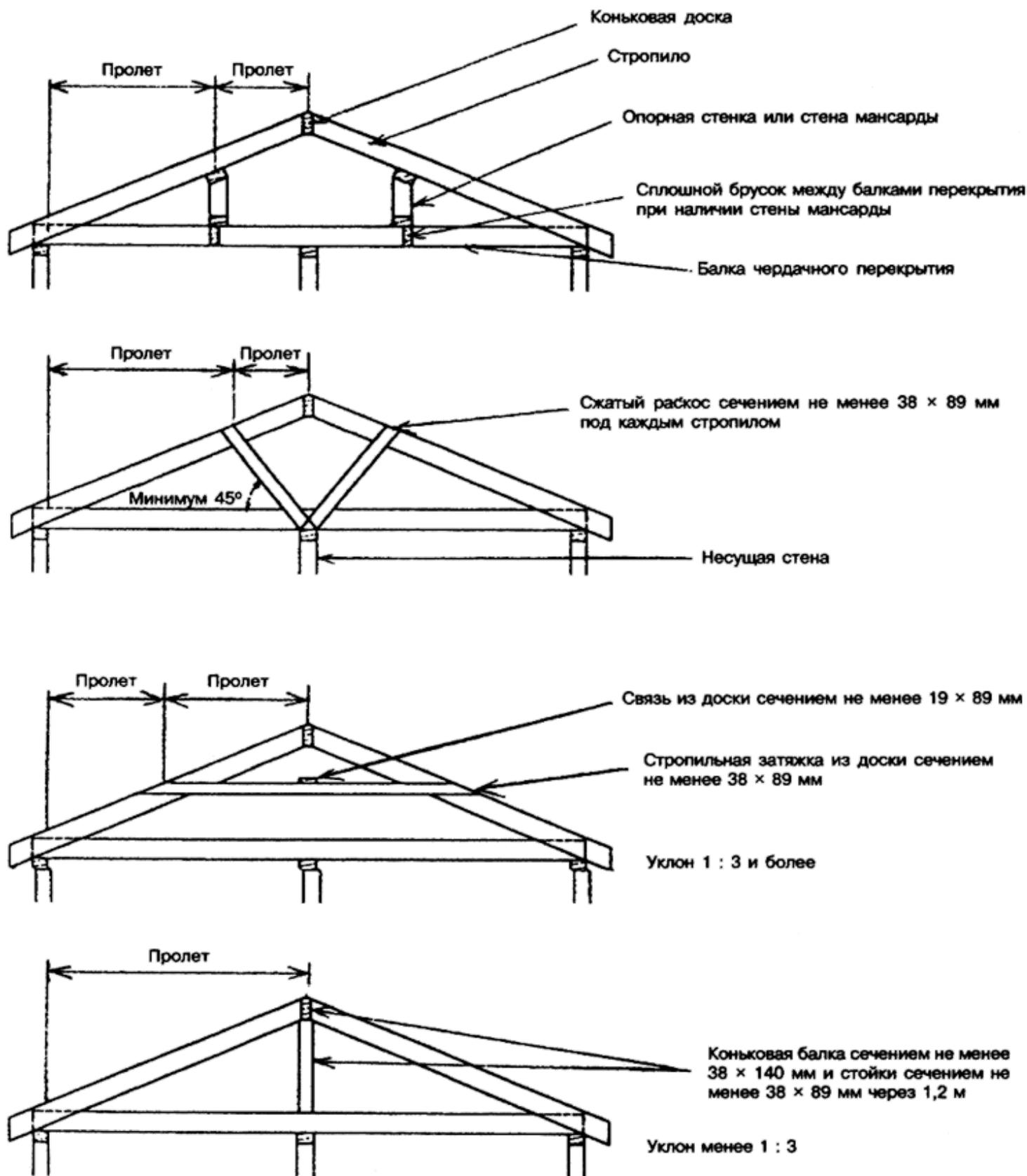
Рисунок 8-1 - Элементы несущего каркаса скатной крыши
