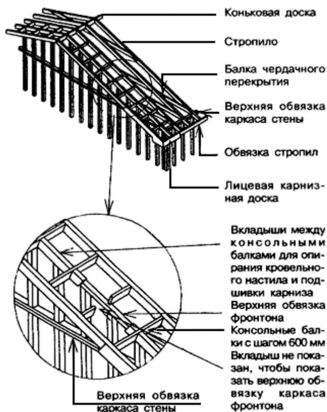
Рисунок 8-7 - Карниз над фронтоном с выносом более 300 мм
