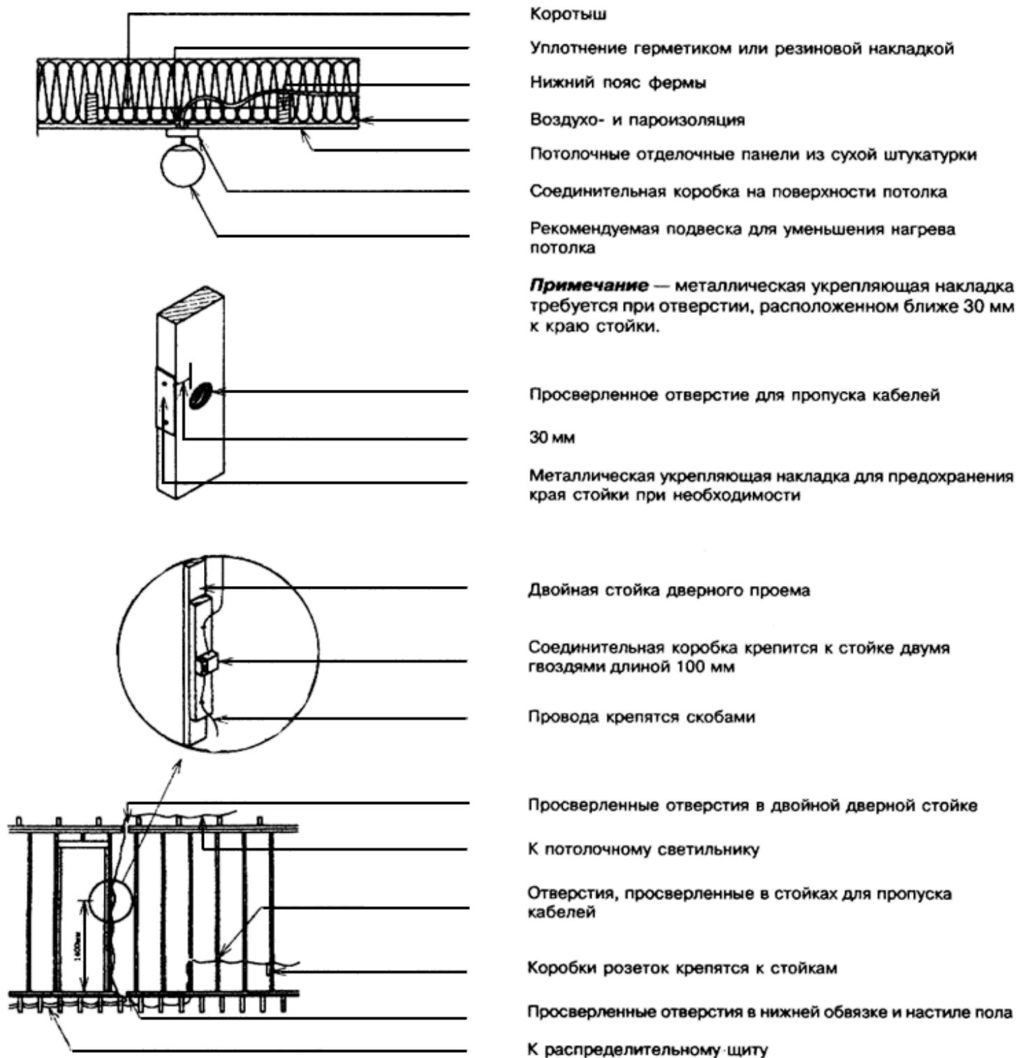
Рисунок 13-9 - Прокладка электрических проводов в элементах каркаса
