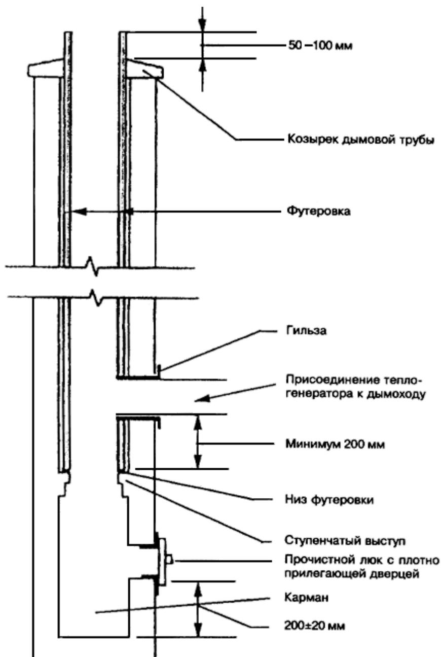
Примечание - Между отверстием прочистного люка и горючим материалом конструкций дома должно быть расстояние не менее 150 мм.
